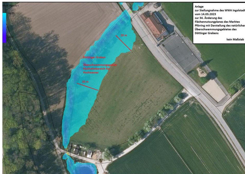
Abb. 7: Darstellung des Überschwemmungsgebietes des Grabens 5
